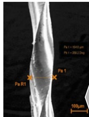
Fig. 3 Limas tamanho 015, medida de d1 junto à primeira região de corte.
